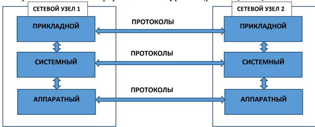
Рис. 6. Упрощенная модель взаимодействия информационных систем
