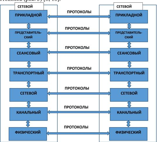
Рис. 5. Стандартная модель стека протоколов
